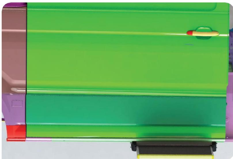
1. Placez provisoirement le marchepied sous le véhicule, alignez-le et localisez les points de fixation possibles.
