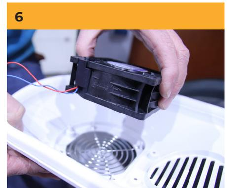
Placez le protège-doigts (grille) et l'extracteur d'air correctement dans le couvercle (avec la flèche vers le haut).
