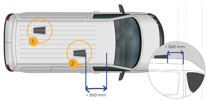
En cas d'un R+, essayez autant que possible de le placer au centre du toit, en mesurant à partir de la cloison jusqu'au hayon ou aux portes arrière.
