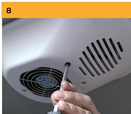
Fixez le couvercle du module électrique à l'aide des trois vis fournies.
