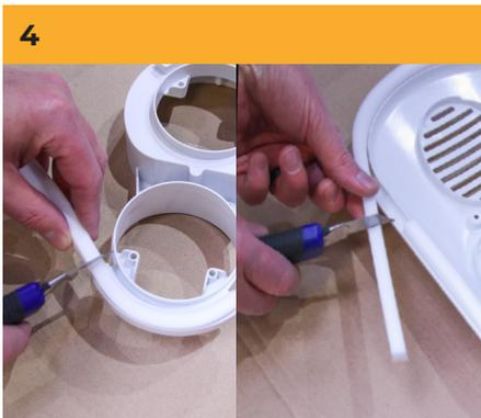
Vérifiez si la partie intermédiaire et le couvercle du module électrique sont pourvus d'un joint mousse. Si celui-ci est fourni séparément, posez vous-même le joint aussi bien sur la partie intermédiaire que sur le couvercle.
