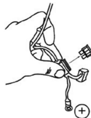
Les câbles doivent être posés à travers l'habitacle. Le contacteur de porte doit être posé séparément vers la porte et le câble du moteur/de la LED vers l'extérieur, vers le marchepied.
